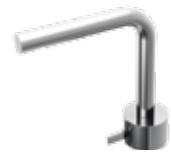
ART. A504WF Miscelatore lavabo monoforo, h. 21,6 cm, interasse bocca 15,5 cm / Cartuccia tradizionale. Single-hole washbasin mixer, h. 21,6 cm, spout projection 15,5 cm / Traditional cartridge. Mitigeur lavabo monotrou, h. 21,6 cm, entraxe bec 15,5 cm, / Cartouche traditionnelle. 1-Loch-Waschtischmischer, H. 21,6 cm, Achsabstand Auslauf 15,5 cm / Standardkartusche. Monomando lavabo, h. 21,6 cm, distancia a chorro 15,5 cm / Cartucho tradicional.
