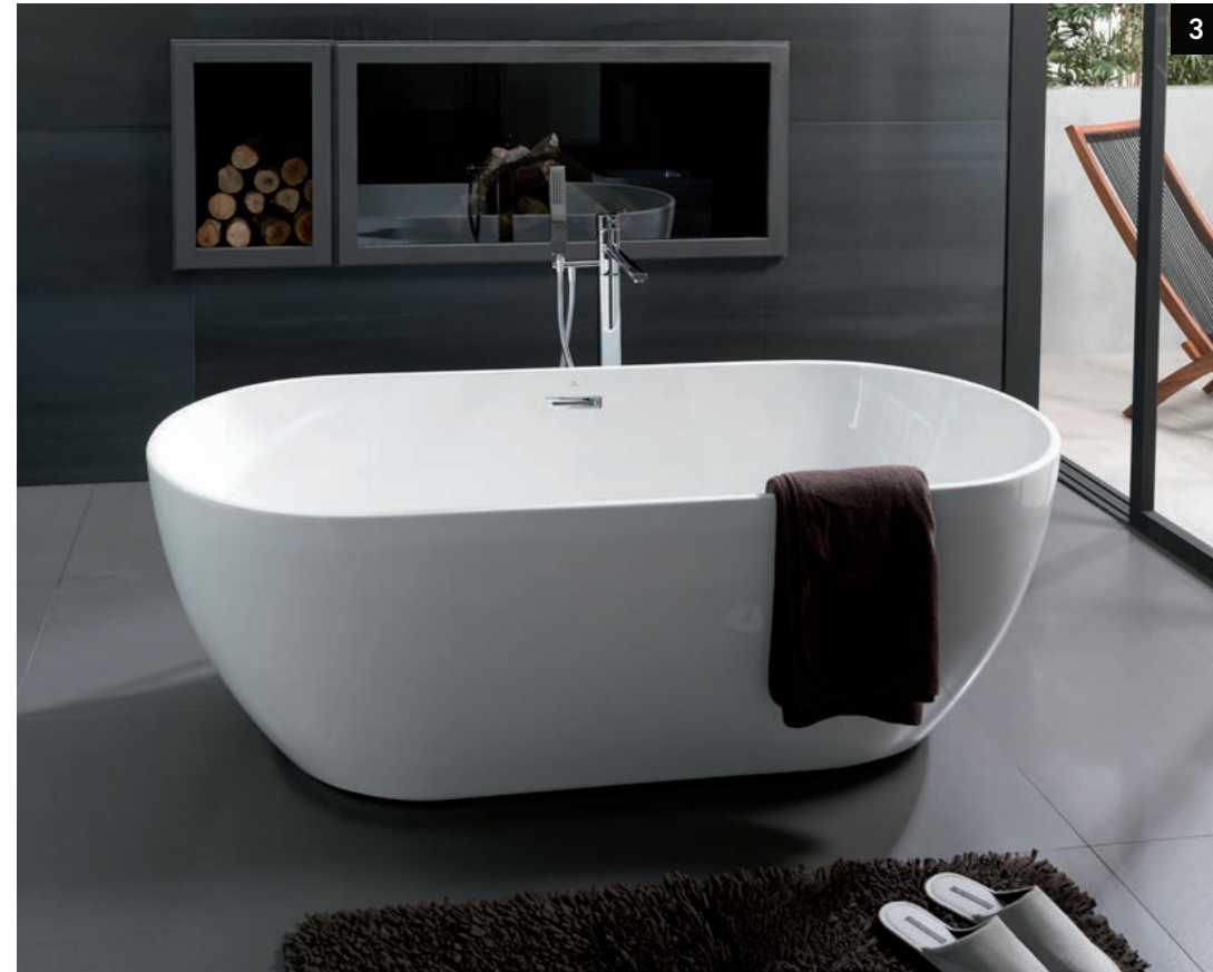
3 Bañera Lounge 170 cm x 75 cm. Bañera sin equipamiento electrónico, exenta, sin grifería, formato oval, monocasco, desagüe central, acrílico sanitario. Es necesario pedir el sifón Next 100158208. Monomando baño/ducha instalación a pavimento NK Concept.
